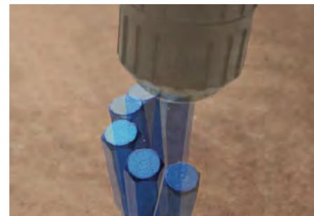
1 Para evitar el deslizamiento de la broca, empezar a taladrar con una inclinación de un angulo de 45°.
